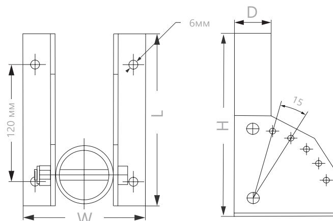
Кронштейн стеновой с переменным углом ДС-1 ТМ Feron предназначен для крепления консольных светильников к стене.
